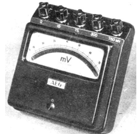
Unten: Bild 2. Millivoltmeter mit Trockengleichrichter u. Wandler
